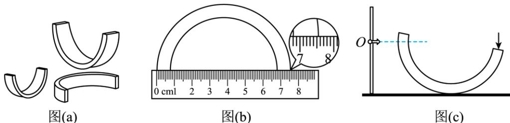
(1) 用刻度尺测量不同颜色积木的外径 $D$ ，其中对蓝色积木的某次测量如图（b）所示，从图中读出 $D = \underline{\hspace{2cm}}$  cm。
