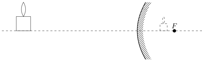
图 5.17 凸镜只能成正立缩小的虚像
