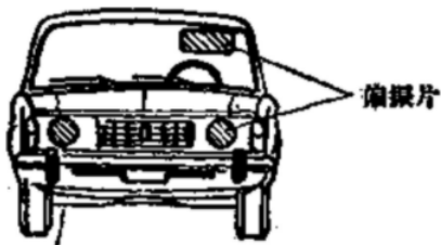
图 6.14 汽车车灯和窗玻璃上的偏振片
